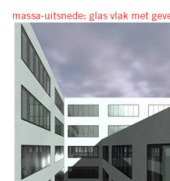
gevelcontour: glas terugliggend verdiept in gevel; negte 300mm
