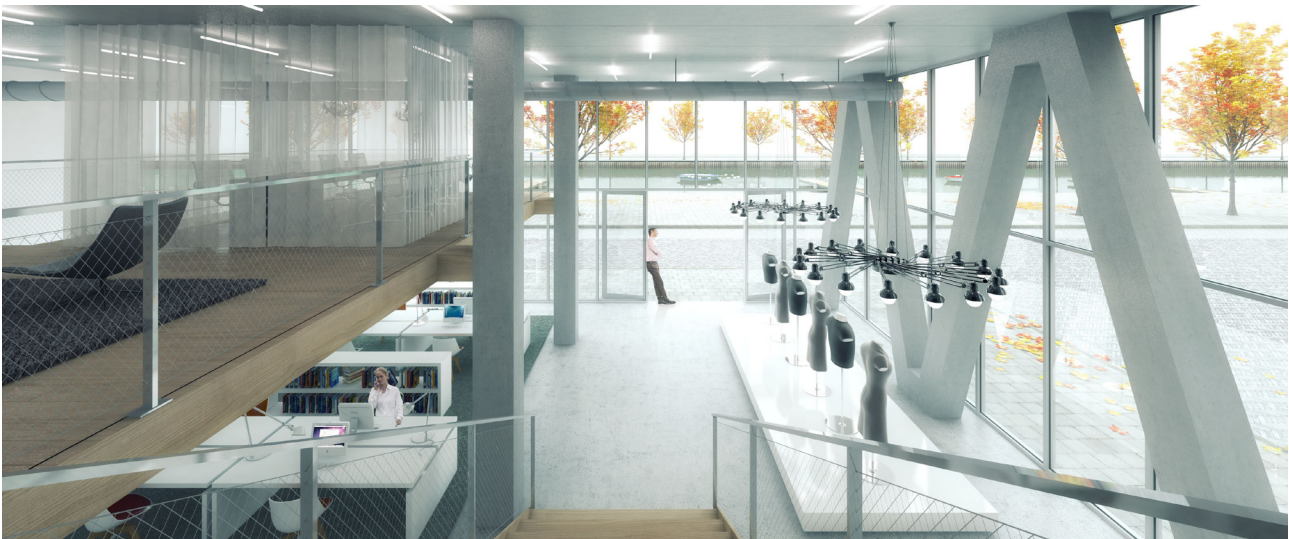
visualisatie interieur commerciële ruimte op de begane grond: deze verdieping is uitgevoerd in beton om als “anker”gewicht te dienen voor de houtconstructie van de er boven gelegen woon-werkverdiepingen.
